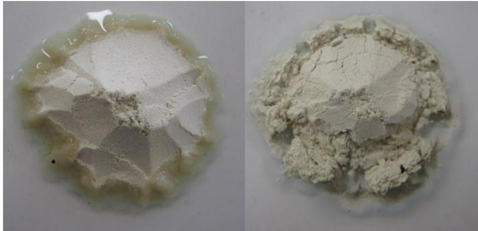
Şekil 6.3 Çankırı-Eldivan yöresi bentonitinin saat camı testi.
