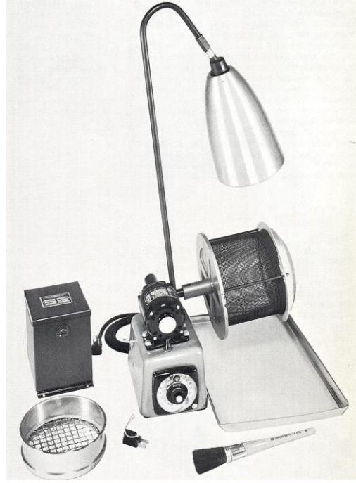
Şekil 5.8 : Kalıplanabilirlik indeksi cihaz ve takımları.
