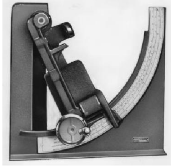
Şekil 5.4 : George Fisher marka AFS standart mukavemet test cihazı [105].
