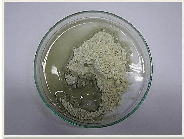
Şekil 6.1 : Deneyde kullanılan bentonitin HCl ile tepkime analiz sonucu.
