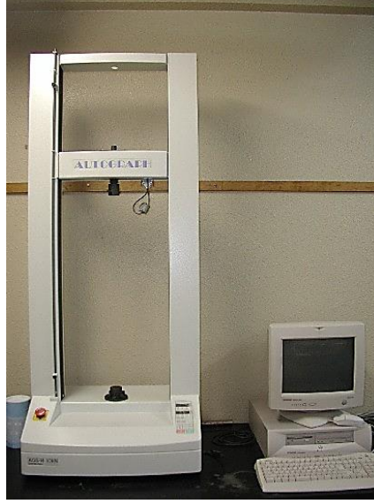
Şekil 5.5 : SHIMADZU AGS-J 10 kN Universal Çekme ve Basma Cihazı.
