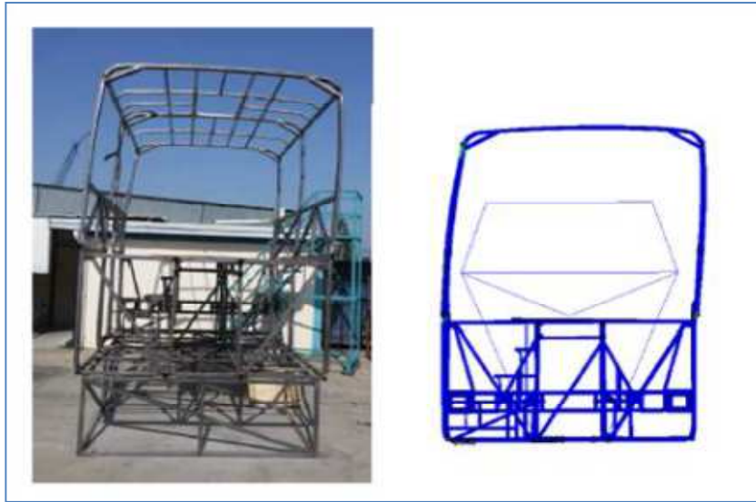
Şekil 4.9 : Kısmi gövdenin analiz ve test sonuçlarının karşılaştırılması.
