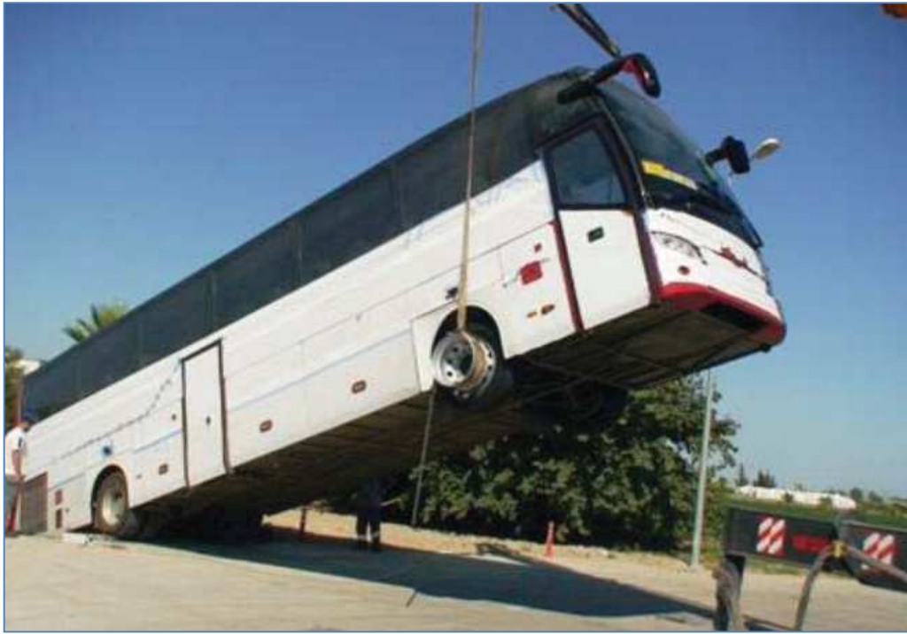
Şekil 5.4 : Gövde açısı ve arka tekerleklerin ağırlıklarının ölçülmesi.
