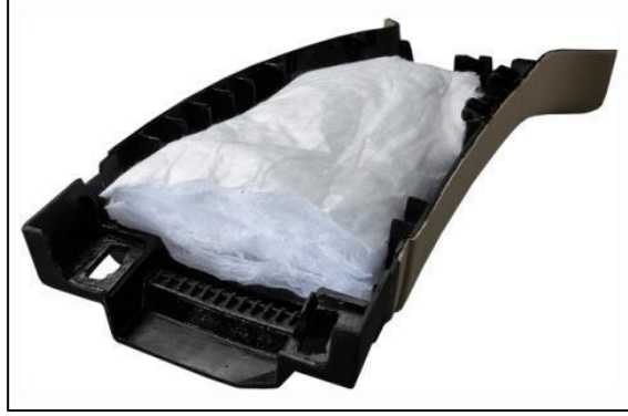
Şekil 4.12 : Trim döşemesi PET mikrofiber uygulama örneği
