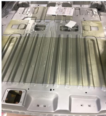
Şekil 4.16 : Araç gövdesi üzerindeki titreşim sönümlenme elemanları
