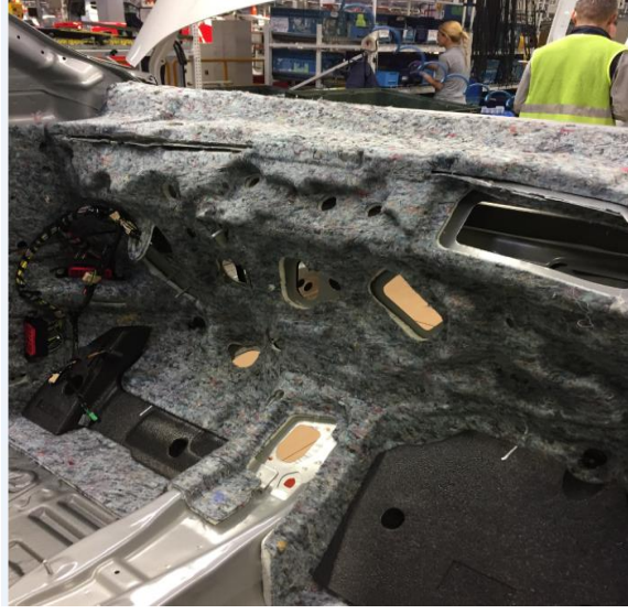
Şekil 4.10 : Ön göğüs ses izolasyonu uygulama örneği
