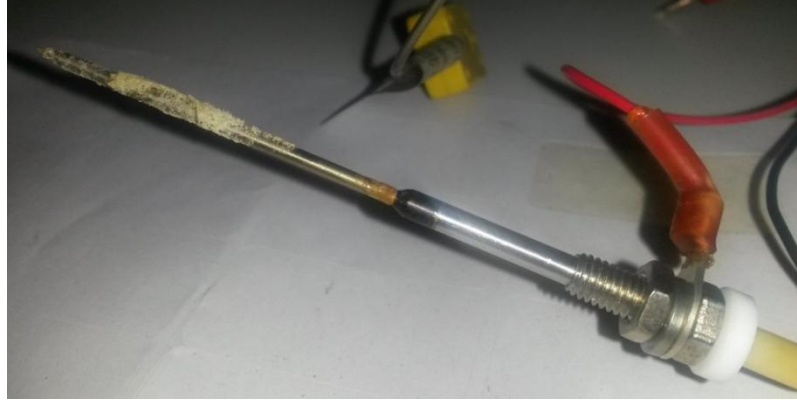
Şekil 4.58 : MS probu üzerinde sarı partiküllerin (elementel kükürt) görüntüsü.
