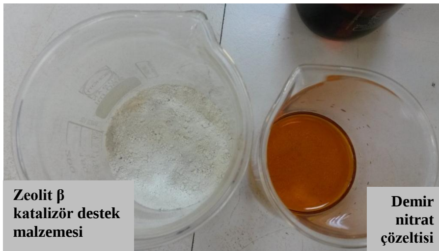
Şekil 3.1 : Fe/Z \beta katalizörünün ıslak emdirme yöntemi ile hazırlanması.
