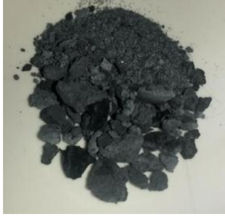
Şekil 4.51 : CO+H 2 ile 700°C ve 1 atm’de (%20 CO, %30 H 2 ve %50 N 2 ile 800 ppmv NH 3 ) yapılan deney ardından reaktör içinde oluşan kok.
