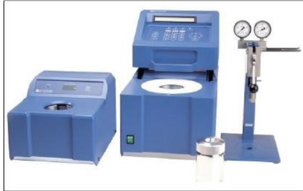
Şekil 4.1: Isıl değer analizinde kullanılan kalorimetre cihazı.
