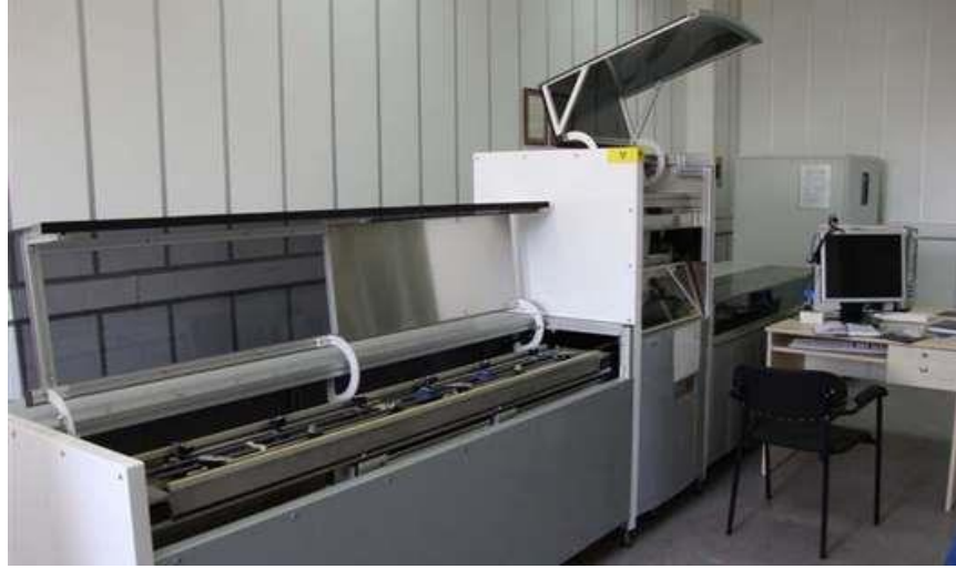
Şekil 2.1 : ITU-EMCOL karot laboratuvarındaki ITRAX mikro XRF karot tarayıcısı
