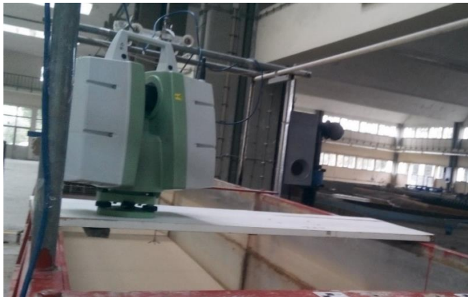
Şekil 3.6 : Lazer tarayıcı istasyon noktası örneği.
