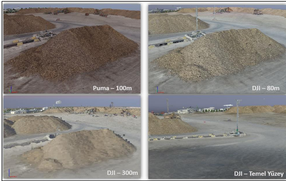
Şekil 4.33 : Farklı parametrelerdeki silo yığını nokta bulutu.
