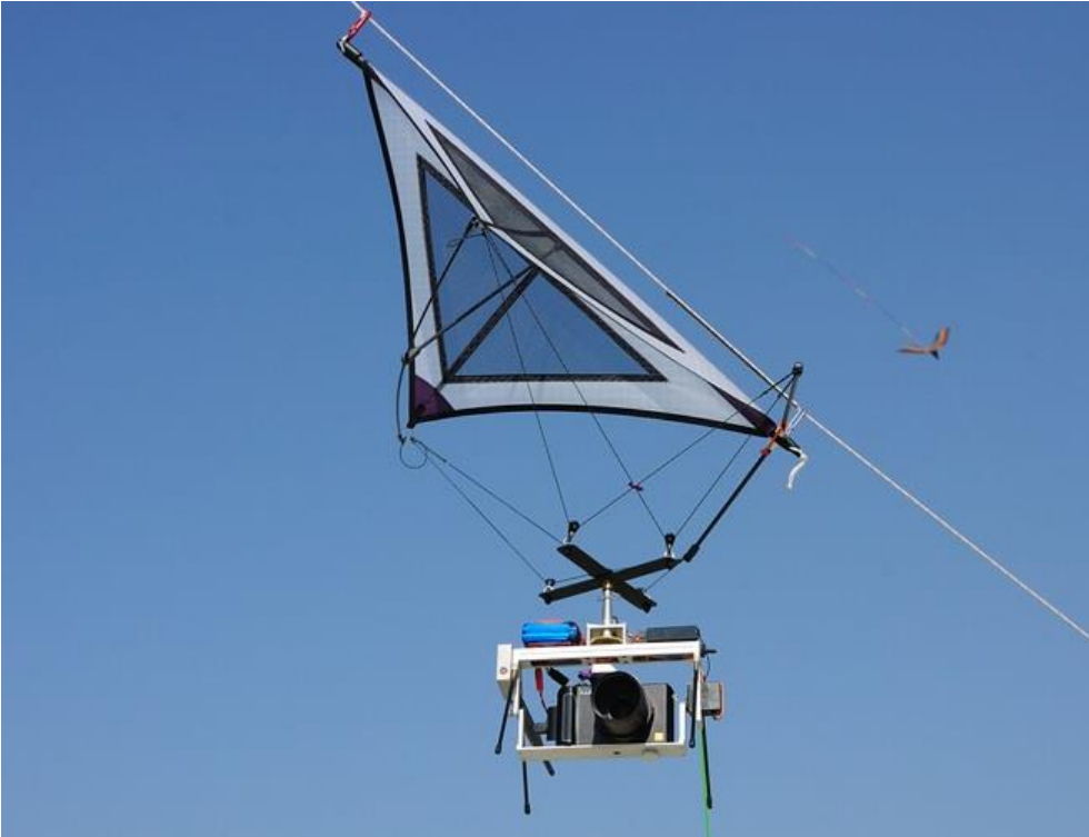
Şekil 2.4 : Hava fotoğrafı çekerken uçurtmanın havadaki görünümü.
