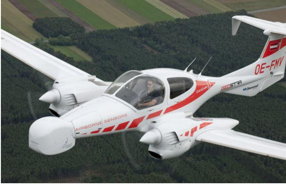
Şekil 2.3 : Hava fotogrametrisi için gerekli verilerin toplandığı ve kaydedildiği uçak.
