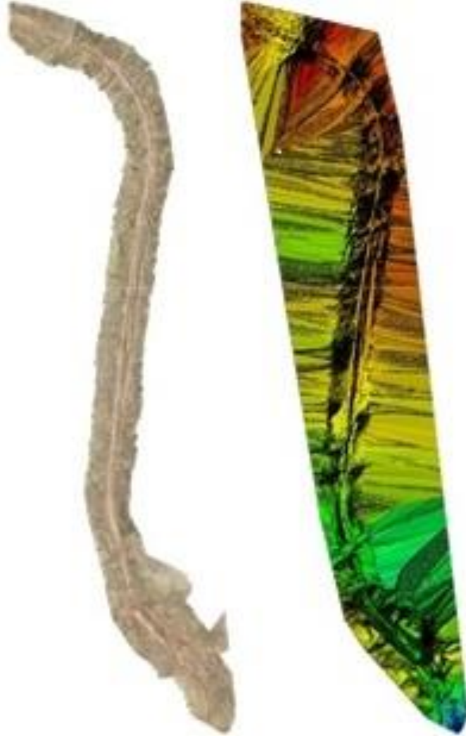
Şekil A.1 : Sıkıştırma öncesi ortomozaik ve karşılık gelen aralıktaki DSM.
