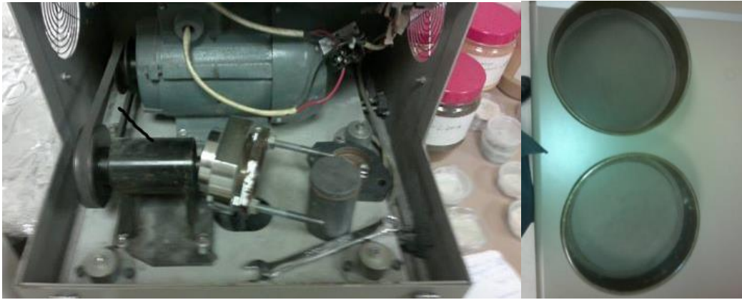
Şekil 3.1 : Bilyalı öğütücü ve 40 µm’lik elek.
