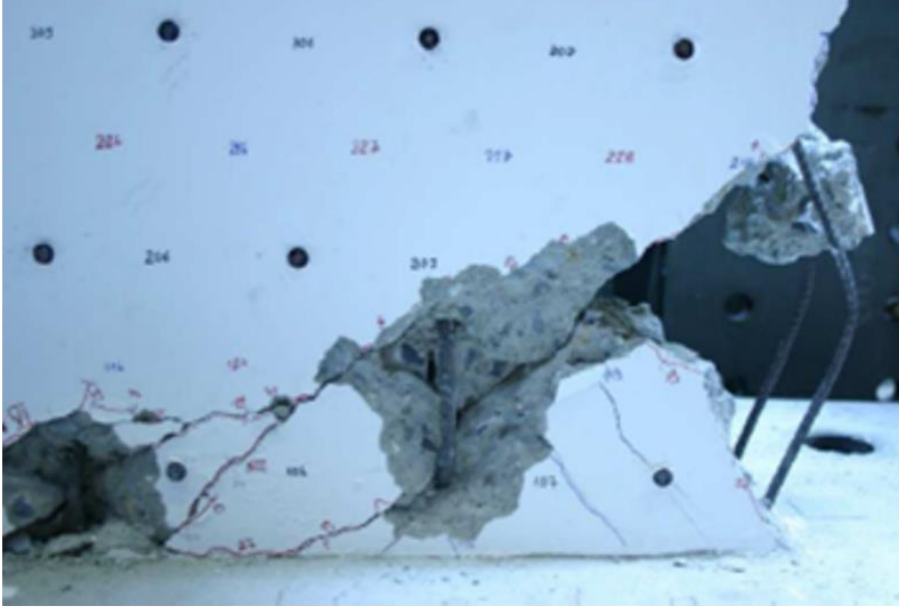
Şekil 2.4 : M2 numunesinin uç bölgelerinde donatı burkulması [Greifenhagen ve Lestuzzi (2005)]
