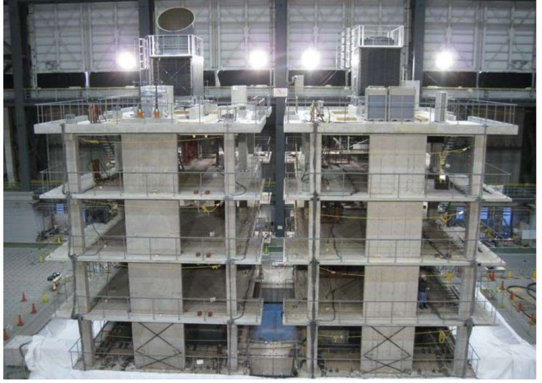
Şekil 2.1: E-Defense sarsma masası ve deney binaları ( https://nees.org/warehouse/project/1005 ).
