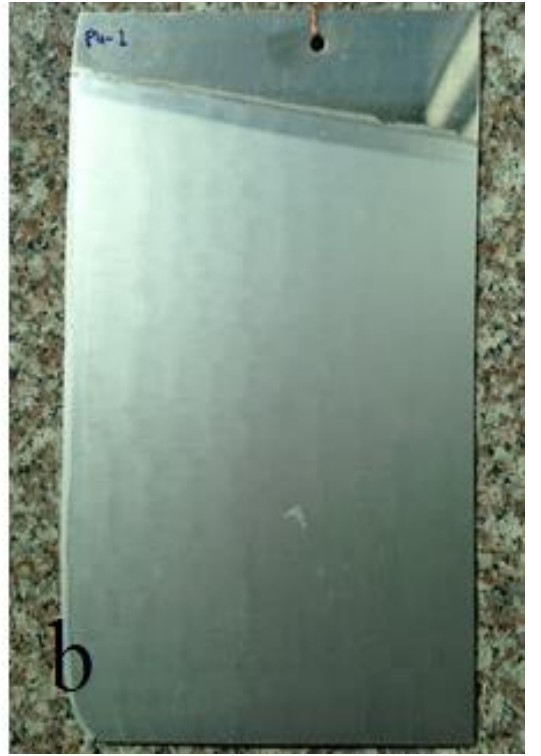
Şekil 5.34 : 4.Proses ile üretilen levhanın anodizasyon sonrası görüntüsü: a) üst yüzey, b) alt yüzey.
