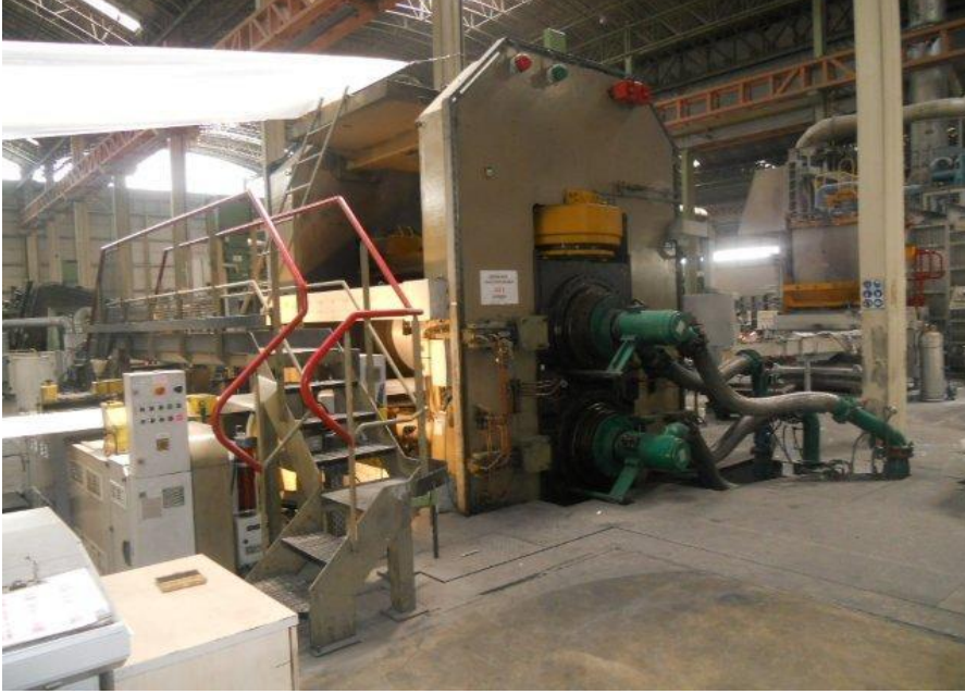
Şekil 5.2 : Novelis Pechiney Jumbo 3 CM döküm makinası.
