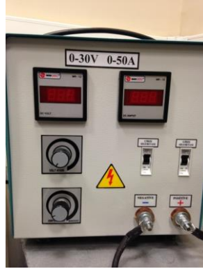
Şekil 5.30 : Anodizasyon işleminde kullanılan doğru akım güç kaynağı
