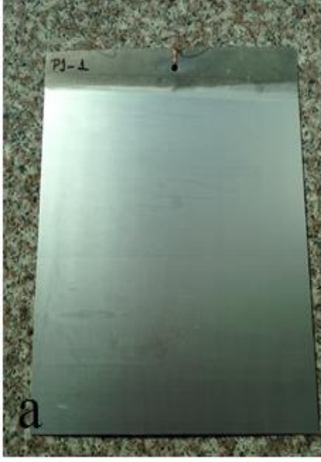
Şekil 5.31 : 1.Proses ile üretilen levhanın anodizasyon sonrası görüntüsü: a) üst yüzey, b) alt yüzey.
