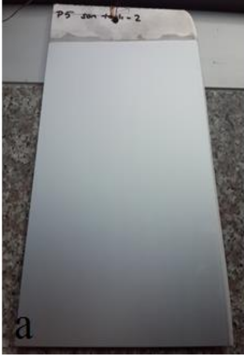
Şekil 5.35 : 5.Proses ile üretilen levhanın anodizasyon sonrası görüntüsü: a) üst yüzey, b) alt yüzey.
