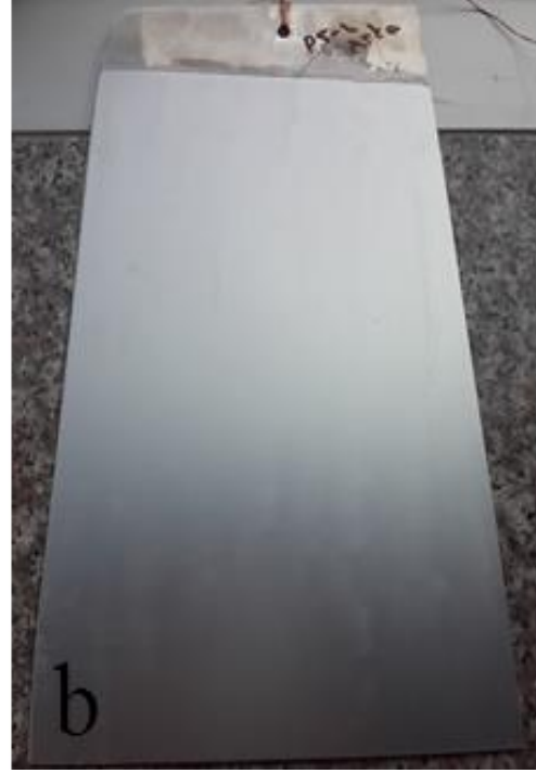
Şekil 5.35 : 5.Proses ile üretilen levhanın anodizasyon sonrası görüntüsü: a) üst yüzey, b) alt yüzey.
