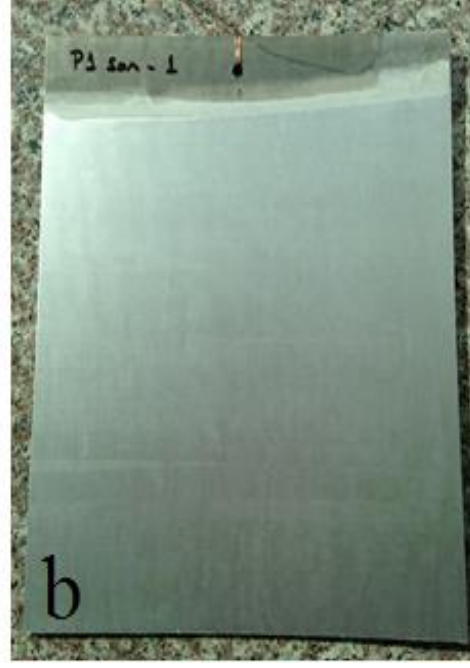
Şekil 5.31 : 1.Proses ile üretilen levhanın anodizasyon sonrası görüntüsü: a) üst yüzey, b) alt yüzey.
