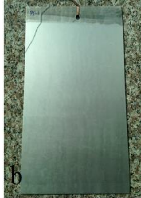
Şekil 5.32 : 2.Proses ile üretilen levhanın anodizasyon sonrası görüntüsü: a) üst yüzey, b) alt yüzey.
