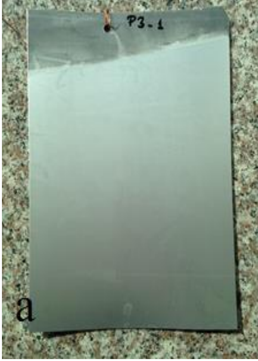
Şekil 5.33 : 3.Proses ile üretilen levhanın anodizasyon sonrası görüntüsü: a) üst yüzey, b) alt yüzey.
