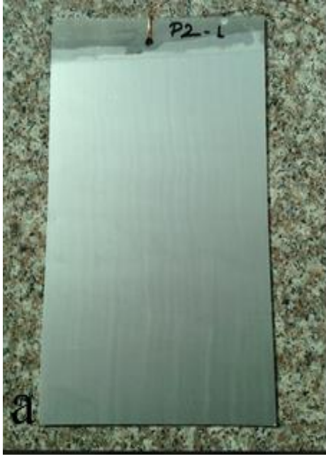
Şekil 5.32 : 2.Proses ile üretilen levhanın anodizasyon sonrası görüntüsü: a) üst yüzey, b) alt yüzey.
