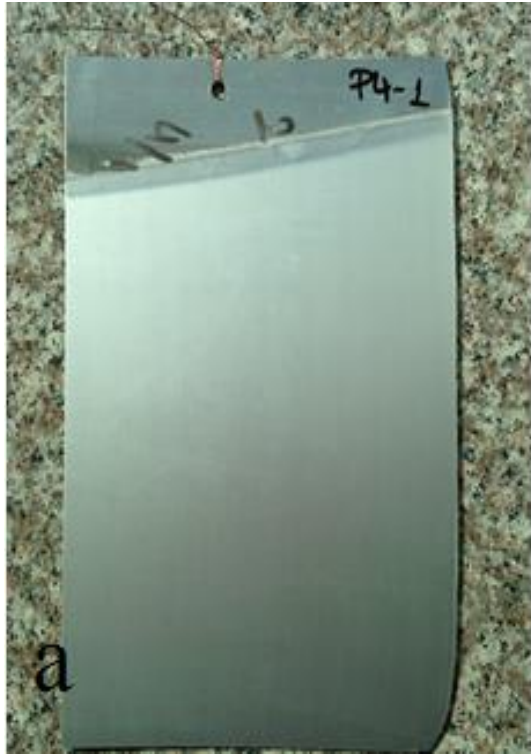
Şekil 5.34 : 4.Proses ile üretilen levhanın anodizasyon sonrası görüntüsü: a) üst yüzey, b) alt yüzey.
