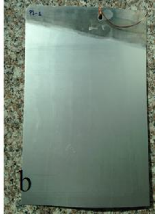
Şekil 5.33 : 3.Proses ile üretilen levhanın anodizasyon sonrası görüntüsü: a) üst yüzey, b) alt yüzey.
