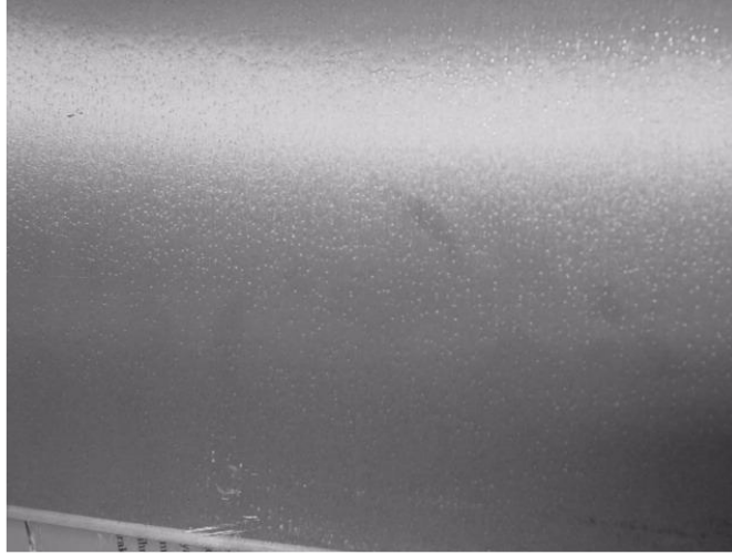
Şekil 2.9 : Merdane çatlađının levhada oluşturduđu yüzey kusurları [15].
