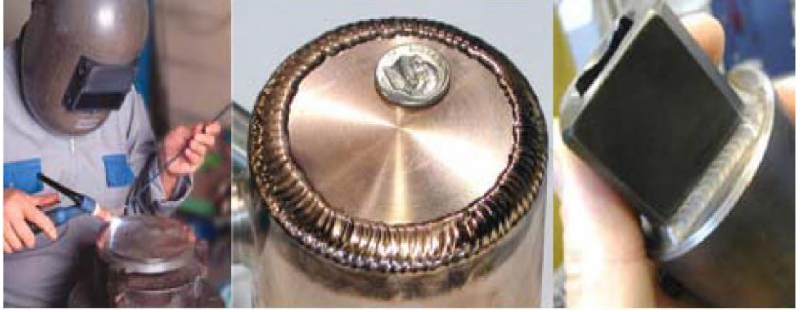
Şekil 3.2 : TIG kaynağı uygulamaları [11].
