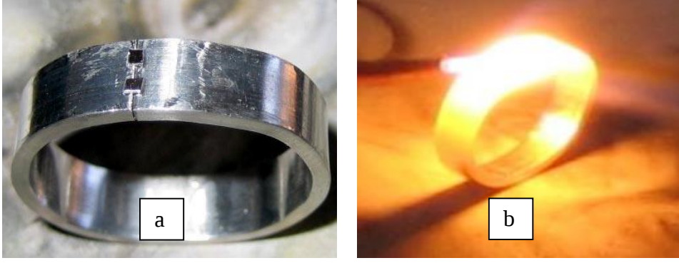
Şekil 5.1 : Bükülerek Yuvarlatılmış yüzük ve lehim için uçlarına yerleştirilmiş ilave metal parçalar (a) ve sert lehim yapılmış yüzük(b) [27-28].
