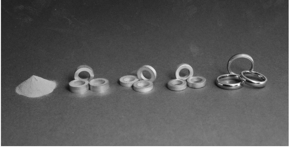
Şekil 5.4 : Toz halindeki malzemenin önce pul biçiminde şekillendirilmiş, ardından sinterlenmiş ve en sonunda bitirme işlemleri ile elde edilmiş yüzük biçimleri [32].
