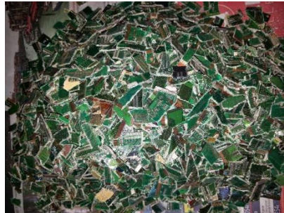
Şekil 5.2: Öğütme öncesi ufak parçalara ayrılmış BDK numuneleri.
