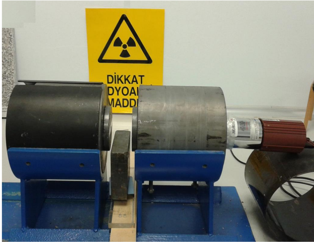
Şekil 5.20 : Gama transmisyon tekniği deney düzeneğinin genel görüntüsü.
