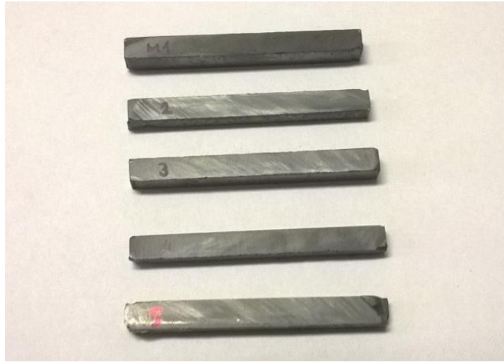
Şekil 5.15 : 3-nokta eğme testi numuneleri (4x5x50 mm).
