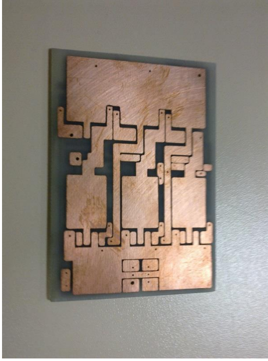
Şekil 5.14: İlk geliştirilen motor sürücü kartlarının baskı devre fotoğrafları.
