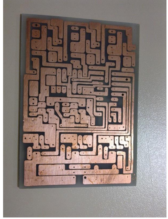
Şekil 5.14: İlk geliştirilen motor sürücü kartlarının baskı devre fotoğrafları.
