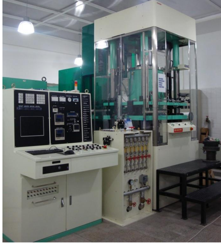
Şekil 5. 1 : Numunelerin üretildiği SPS sistemi.
