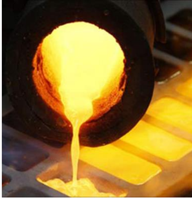
Şekil 2.4: Ergitilmiş altının külçeler halinde dökülmesi [19].
