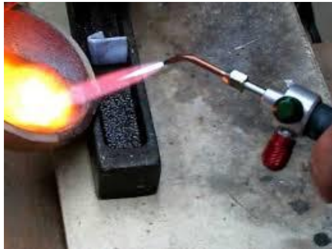
Şekil 3.4: Alaşım metallerinin potada ergitilmesi.
