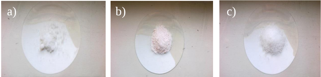
Şekil 4.2: Kullanılan jel öncülleri a) Lityum asetat b) Manganez asetat c) Sitrik asit.
