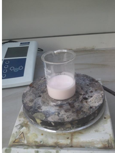
Şekil 4.5 : Jel öncülleri, şelatlaştırmacı ve distile su kullanılarak elde edilen jel.
