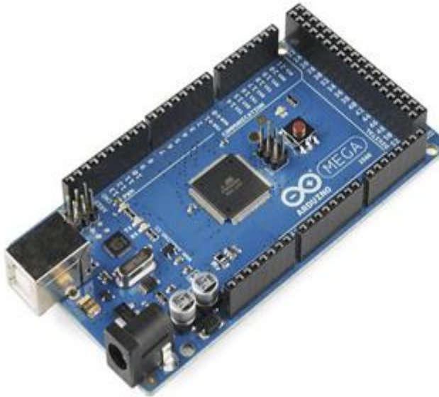
Şekil 3.4 : Arduino mega 2560 ve teknik özellikleri
