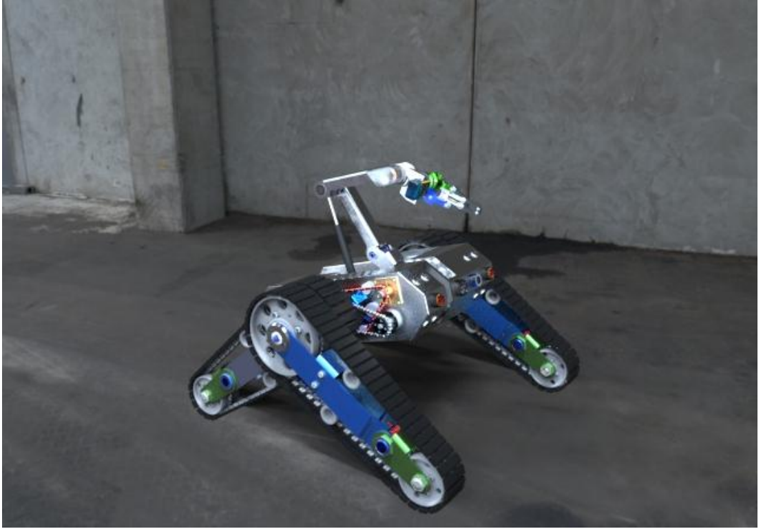
Şekil 2.1: Yanal yönlendirmeli paletli mobil manipülatör
