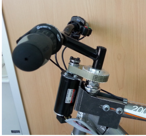
Şekil 4.2: Gidon tahrik mekanizması.
