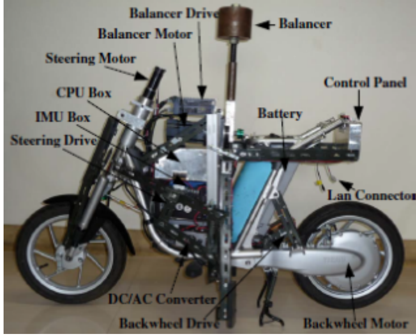
Şekil 1.3: Ters sarkaç yardımıyla bisiklet denge kontrolü [14].
