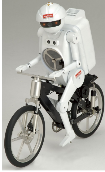
Şekil 1.5: Volan yardımıyla bisiklet denge kontrolü [22].
