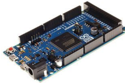
Şekil 4.5: Arduino Due geliştirme kartı.
