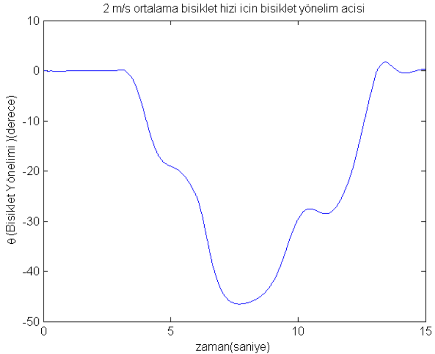
Şekil 3.40: 2 m/s ortalama bisiklet hızı için Z yörüngede \theta açısı.
