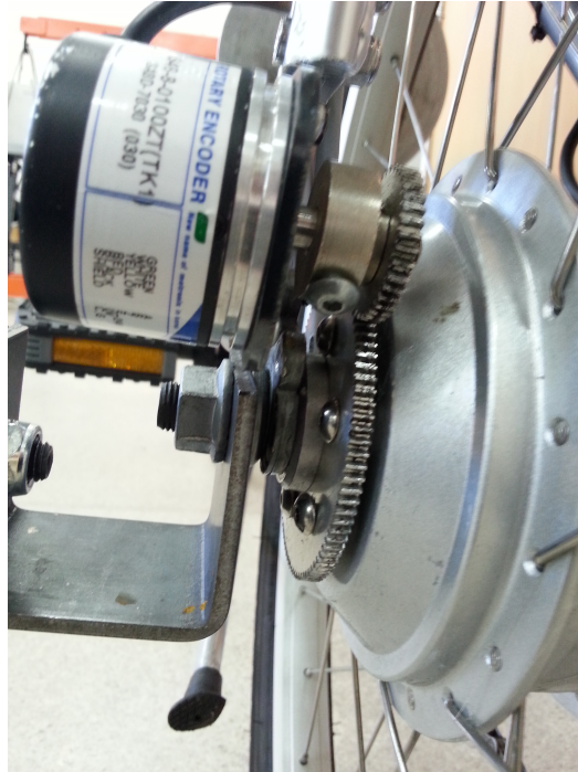
Şekil 4.3: Enkoder dişli sistemi.
