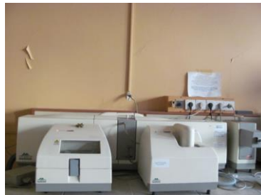
Őekil 4.4 : Malvern™ Mastersizer lazer partik¼l boyut ¼lę¼m cihazı.
