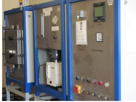
Şekil 4.14 : Linn TM 1800 HT atmosfer kontrollü fırın.
