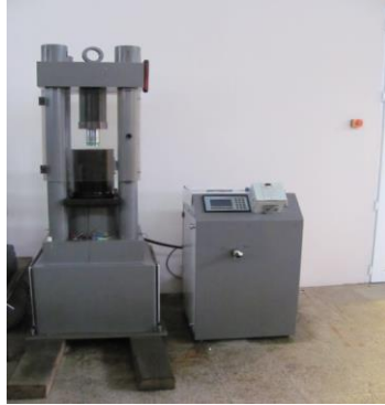
Şekil 4.9 : Alşa Marka Soğuk izostatik pres (SİP).
