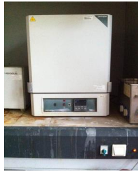
Şekil 4.12 : Protherm marka bağlayıcı giderme fırını.
