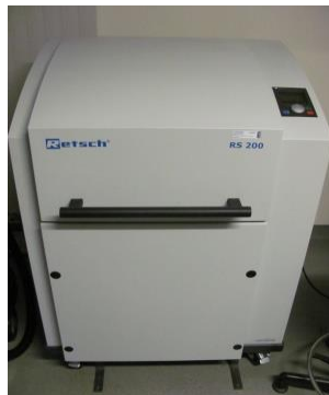
Őekil 4.3 : Retsch®RS 200 tipi titreřimli diskli ¼ę¼t¼c¼.
