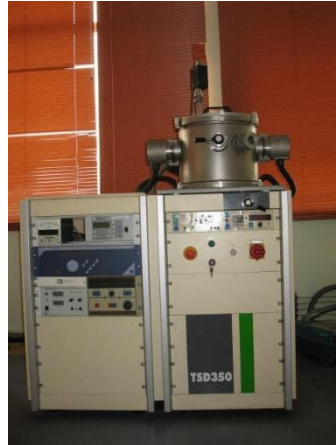
Şekil 3.10 : DC Manyetik Alanda Sıçratma/Plazma Destekli Kimyasal Buhar Biriktirme İnce Film Kaplama Cihazı
