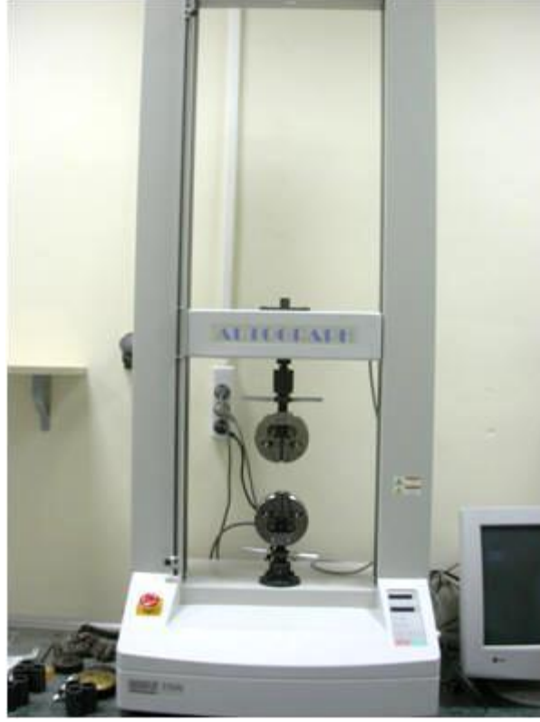
Şekil 3.7: 10 kN kapasiteli elektromekanik kontrollü universal test cihazı.
