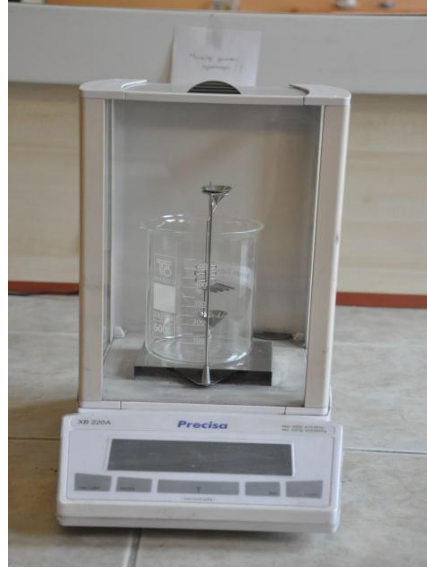
Şekil 3.11: Hassas Terazi ve Arşimet Düzeneği.
