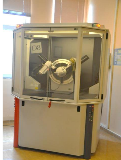
Şekil 3.8: Cu-K \alpha tüplü, Bruker D8 Advance marka X-ışım difraktometresi.
