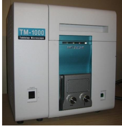
Şekil 3.9 : Hitachi TM-1000 Marka Masa Üstü Taramalı Elektron Mikroskobu.
