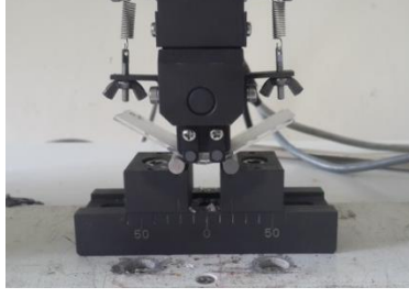
Şekil 5.4: Schimadzu Universal Testing Instrument cihazında dört nokta eğme testi.
