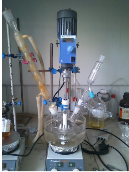
Şekil 3.1 : Reçine yapımı deney düzeneği.
