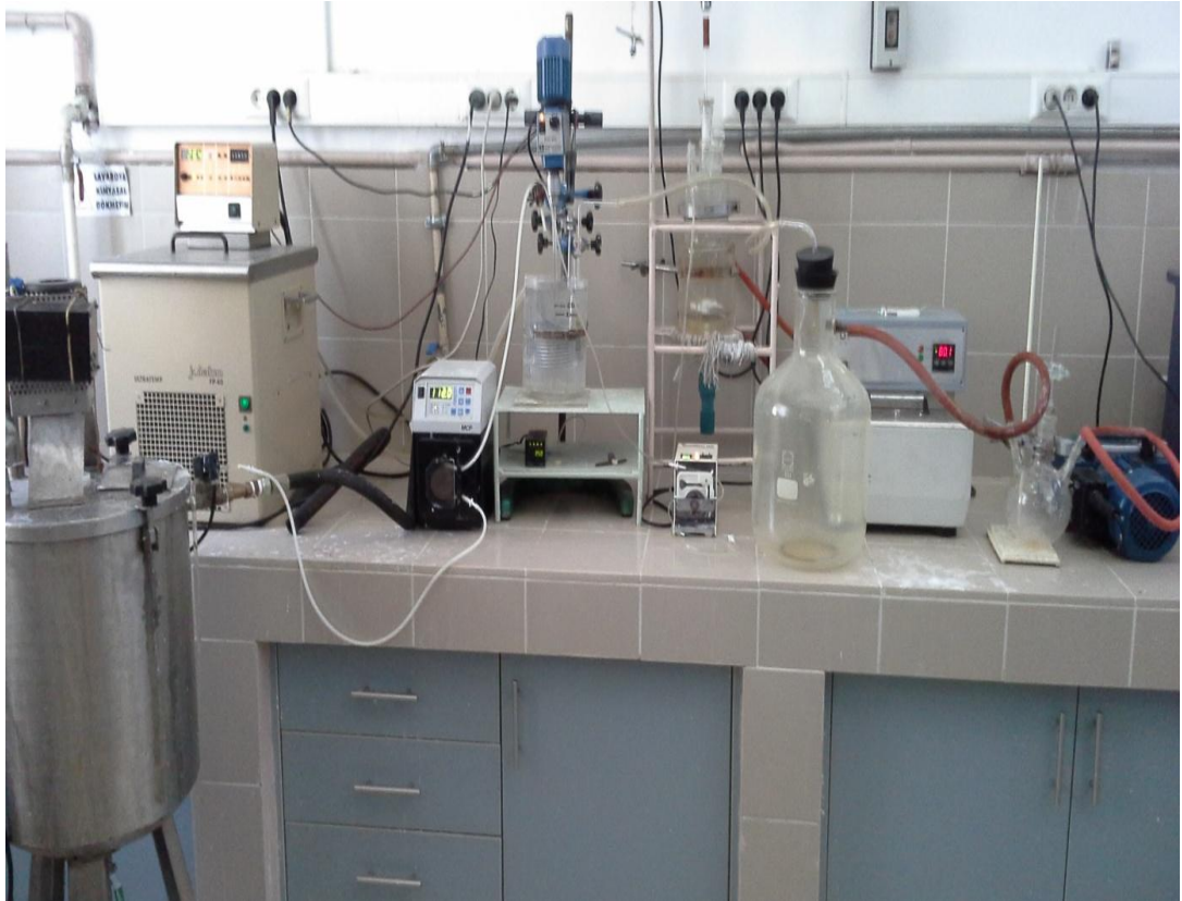
Şekil 3.1 : MSMPR deney sistemi
