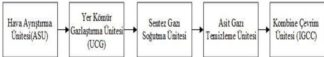
Şekil 2.19: IGCC Güç Tesisinin Blok Diyagramı [4]
