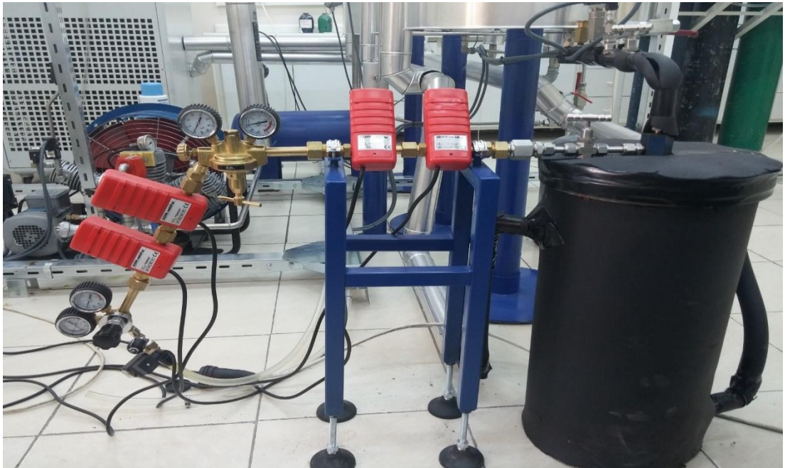
Şekil 4.19 : Karbondioksit depolama tüpünden sonra eklenen ısıtıcı ve regülatörlerin görseli.
