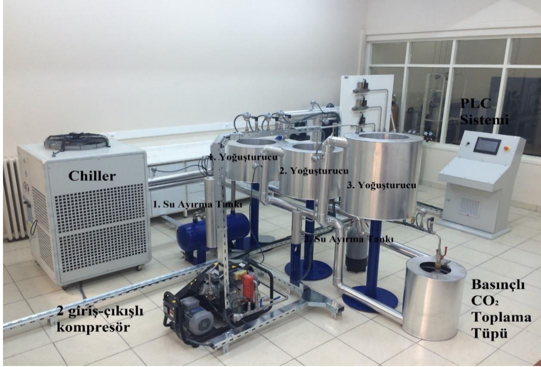
Şekil 4.4 : Laboratuvar ölçekli karbondioksit tutma ve depolama deney düzeneği genel görünüm.
