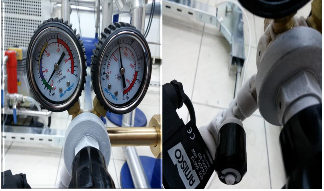
Şekil 4.15 : Regülatörde meydana gelen donma olayının görseli.
