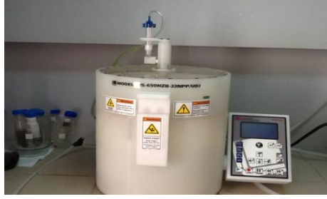
Şekil 5.11: İnce film kaplamada kullanılan dönel kaplama (spin coating ) cihazı
