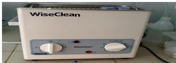
Şekil 5.8: Altlıkların temizleme işleminde kullanılan ultrasonik banyo cihazı
