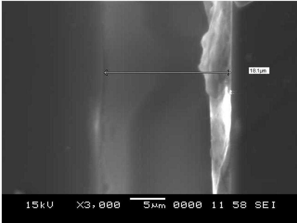
Şekil 3.3: Sandviç hücrelerin aralığını gösteren bir SEM fotoğrafı.
