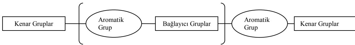
Şekil 2.1: Termotropik sıvı kristal moleküllerinin şematik yapısı.
