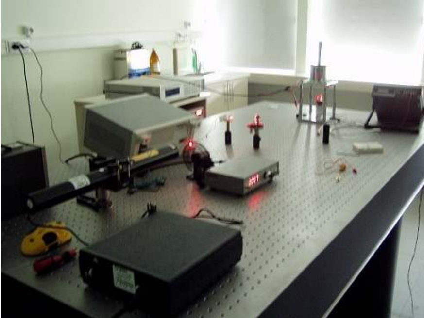
Şekil 3.17: PPE AC kalorimetri düzeneğinin bir fotoğrafı.
