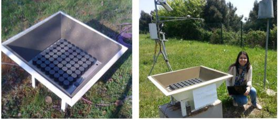
Şekil 3.8: REMTECH PA0 SODAR ölçüm cihazı ve ölçüm yeri.
