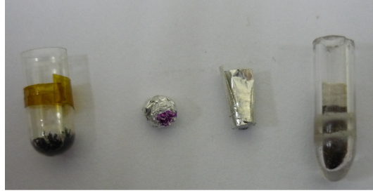
Şekil 5.7: SQUID için hazırlanan örnek kabı, alüminyum örnek kapları (boş ve dolu hali) ve kuartz tüp.
