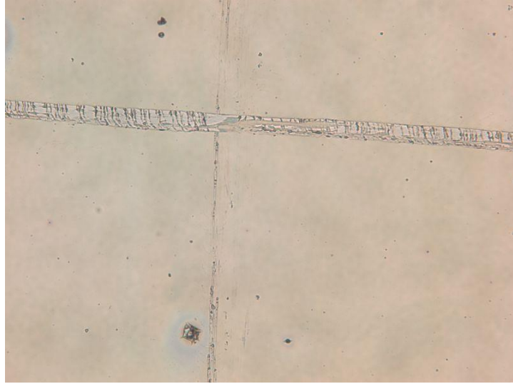
Şekil 5.29 450°C’ de elde edilen sistemin çizildikten sonraki yüzey görüntüsü
