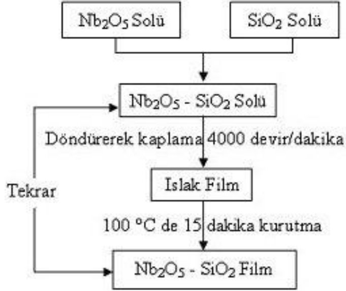
Şekil 5.6 Nb 2 O 5 - SiO 2 karışımli ince filmlerin hazırlanması
