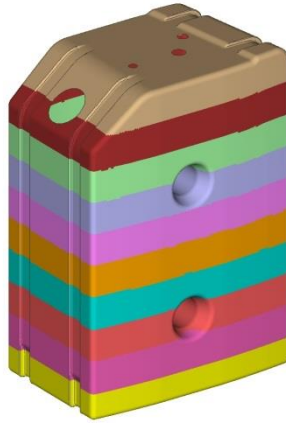
Şekil 5.13 : Yakıt tankının z yönünde dilimlenmiş hali.
