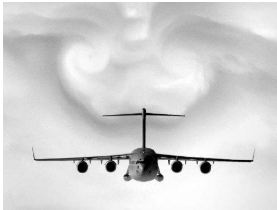
Şekil 2.9 : Kanat ucu girdapları.
