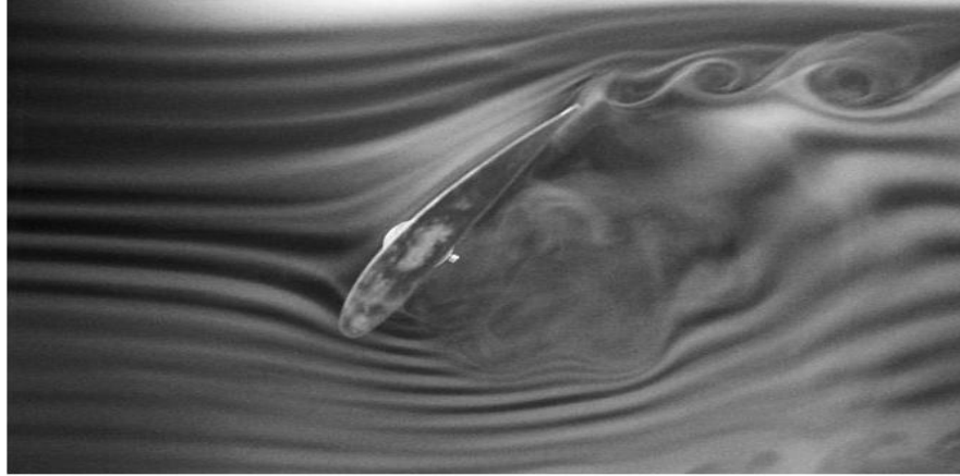
Şekil 3.1: NACA 4412 profili etrafındaki akımın ve firar kenarındaki uç girdaplarının duman ile görüntülenmesi (Smart Blade, 2014).
