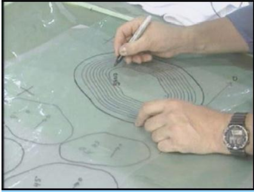
Şekil 5.1 : Islak- elle yatırma tamiri için kumaş boyutlarının örnek modele aktarılması.
