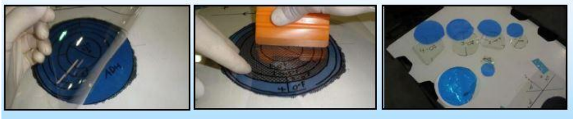
Şekil 4.5 : Tamir katmanlarının serilmesi.
