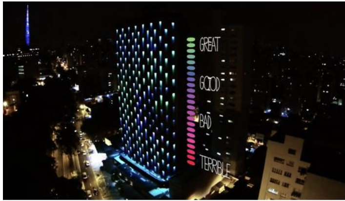
Şekil 4.31 : Bina cephesinin hava kalitesine göre renklenme şeması (URL-94).
