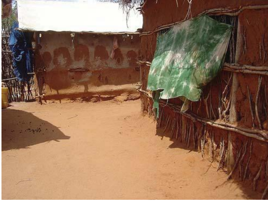
Şekil 3.14: Çamur ve saz kompozisyonu barınak (Sipus,2005).
