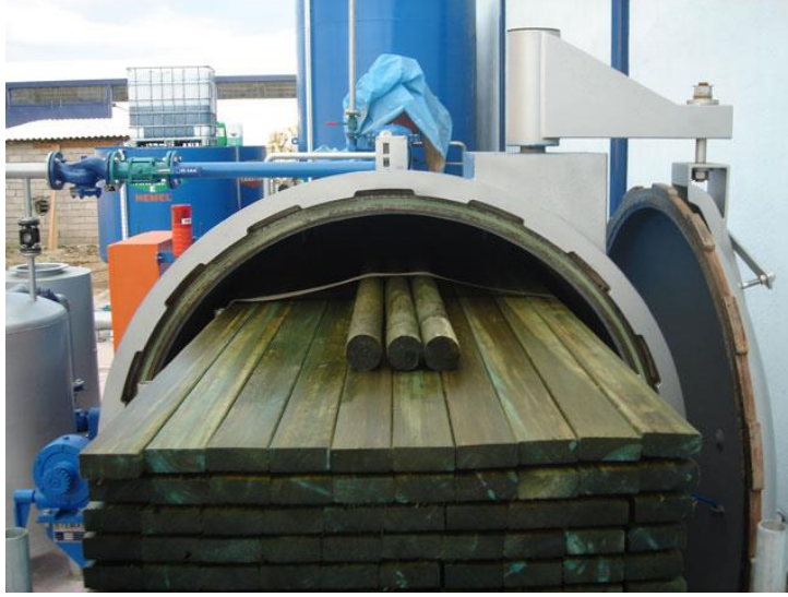
Şekil 3.20 : Ahşap malzemenin borlu bileşikler ile emprenye edilmesi işlemi.
