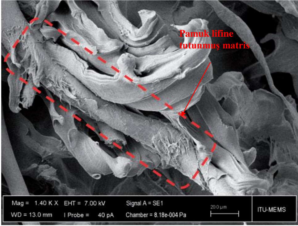
Şekil 5.12 : Bağlayıcı ajan katkılı kompozitlere ait ara yüzey durumu.
