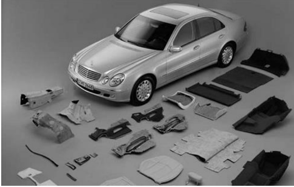
Şekil 2.2 : Mercedes-Benz E serisinde kullanılan farklı doğal lif takviyeli kompozit parçalar [22].
