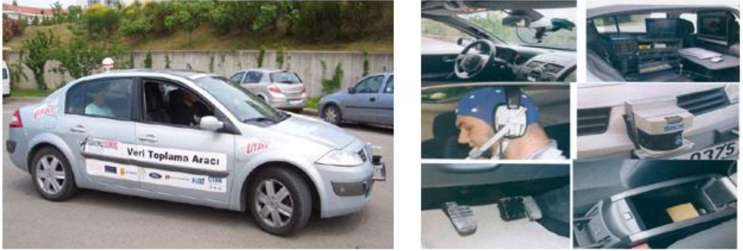
Şekil 2.1 : Uyanık aracı ve araca yerleştirilmiş sensörler.
