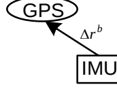
Şekil 5.11 : GPS ile IMU sensörleri arası konum farkı.
