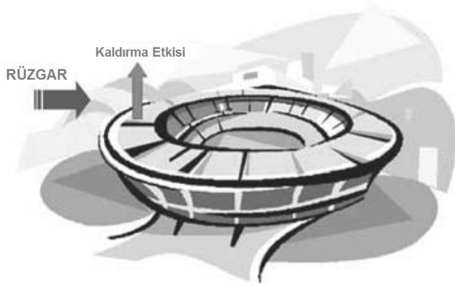
Şekil 1.3 : Stadyum ve arena gibi büyük çatı alanlarına sahip yapılarda meydana gelen rüzgar etkileri.
