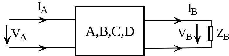
Şekil 4.6 : Enerji İletim Hattı İki Kapılı Modeli [7]
