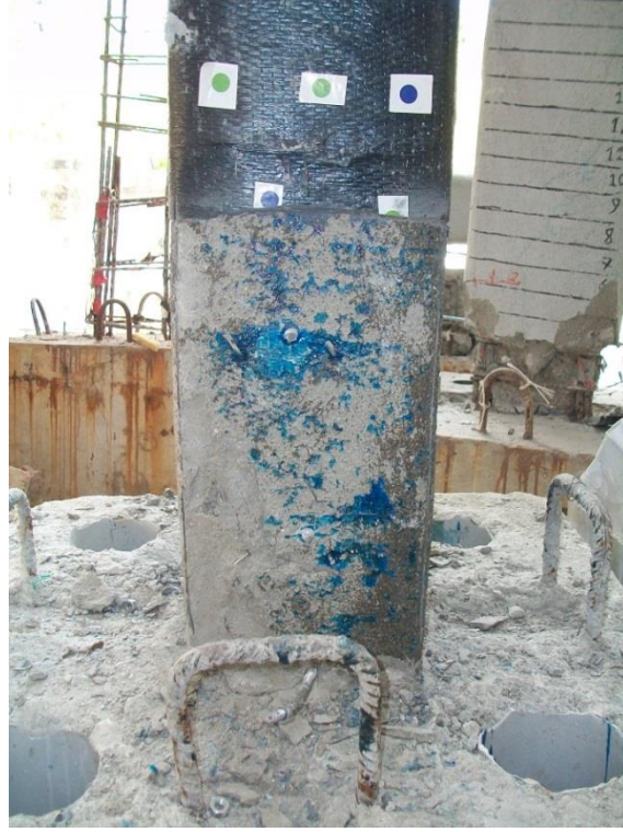
Şekil A.16 : LAM-PB numunesi deney sonrası çatlak kontrolü- deney sonrası.
