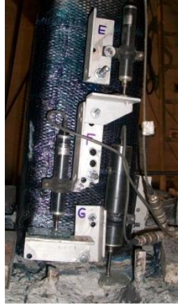
Şekil 4.15 : LAM-LAM numunesi deney sonrası kolon-temel birleşimi.
