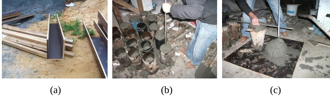
Şekil 2.6 : (a) Kolon kalıp hazırlanışı , (b) Kolon kalıp hazırlanışı, (c) Çökme deneyi.
