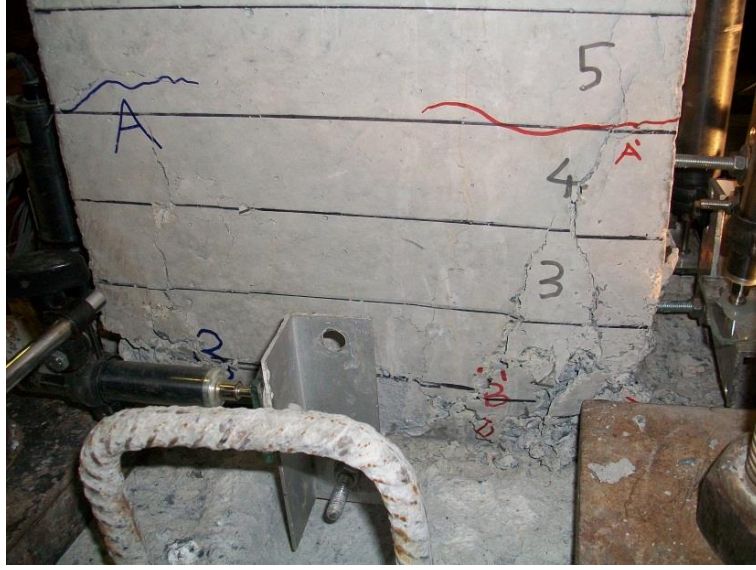
Şekil A.7 : REF numunesi % 8 itme öteleme oranında görünümü.
