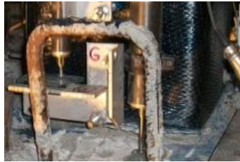
Şekil 4.10 : LAM numunesi deney sonrası kolon tabanı ile temel yüzeyi.
