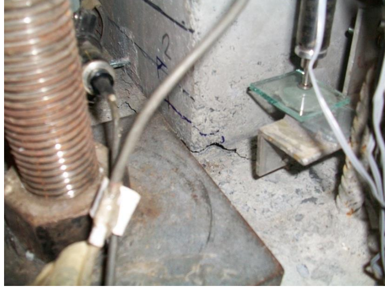
Şekil A.4 : REF numunesi % 4 itme öteleme oranında görünümü.
