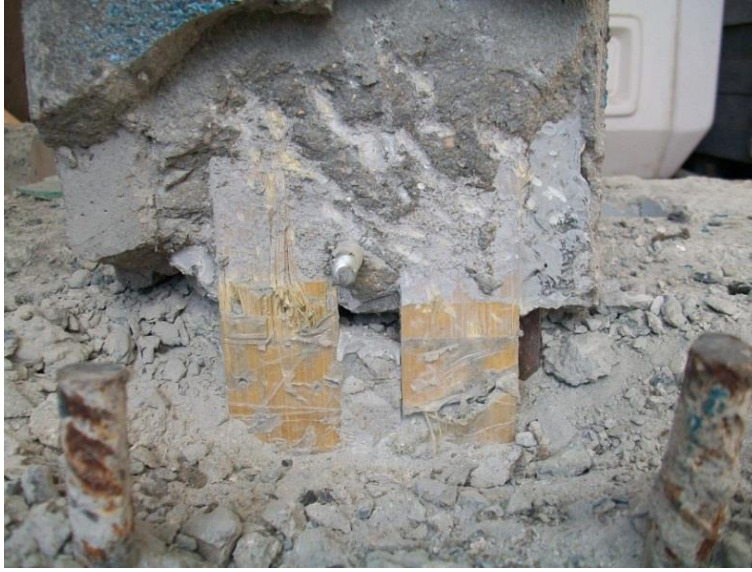
Şekil A.17 : LAM-PB numunesi deney sonrası ankraj kontrolü- deney sonrası.
