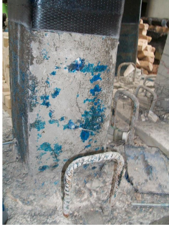
Şekil A.12 : LAM numunesi deney sonrası çatlak kontrolü-deney sonrası.
