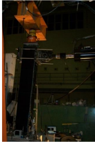
Şekil 4.9 : LAM numunesi deney sonrası ( P= 0 kN, \delta= -82,60 mm).
