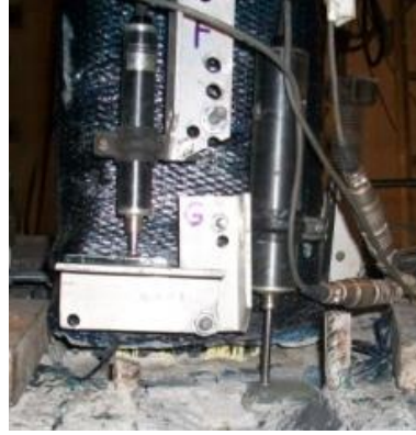
Şekil 4.13 : LAM-LAM numunesi % 8 itme öteleme oranı sonrası kolon-temel birleşimi.
