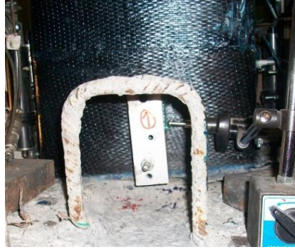
Şekil 4.8 : LAM numunesi % 8 öteleme oranı sonrası itmede kolon tabanı ile temel yüzeyi.
