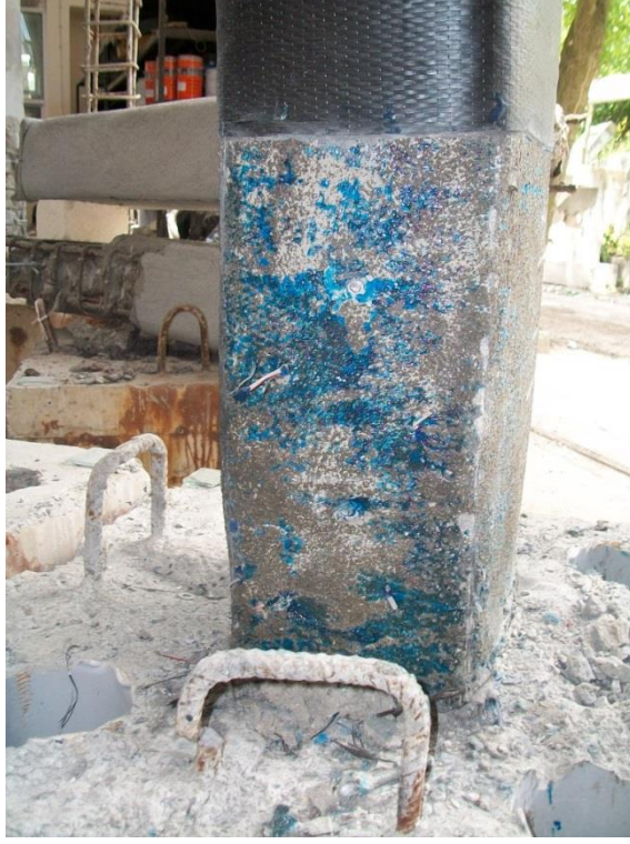
Şekil A.14 : LAM-LAM numunesi deney sonrası çatlak kontrolü-deney sonrası.
