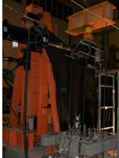
Şekil 4.7 : LAM numunesi % 8 öteleme oranı ile itme sonrası.
