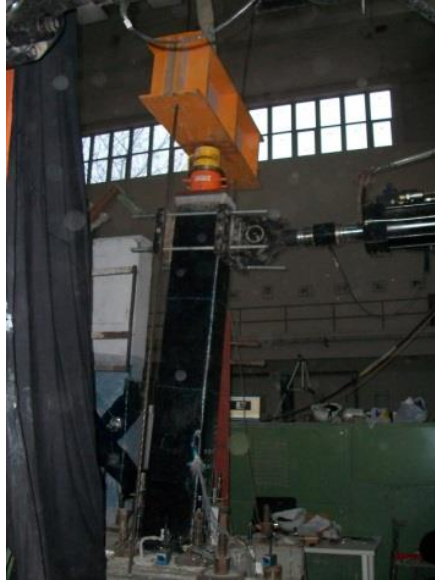
Şekil 4.19 : LAM-PB numunesi deney sonrası ( P=0 kN, \delta = -83,10 mm).
