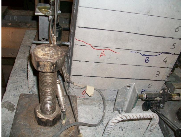
Şekil A.2 : REF numunesi % 2 çekme öteleme oranında görünümü.
