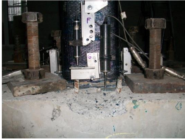
Şekil 4.20 : LAM-PB numunesi deney sonrası kolon tabanı ile temel yüzeyi.
