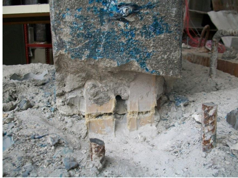
Şekil A.15 : LAM-LAM numunesi deney sonrası ankraj kontrolü-deney sonrası.
