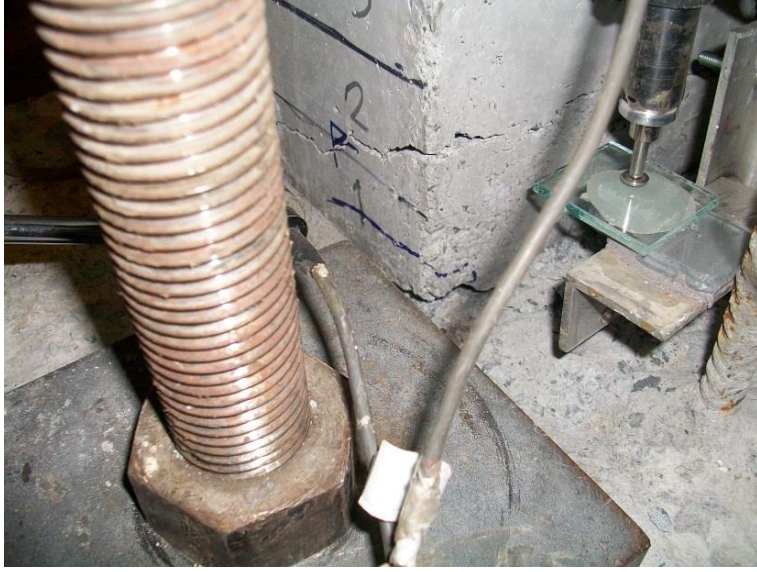
Şekil A.5 : REF numunesi % 6 itme öteleme oranında görünümü.
