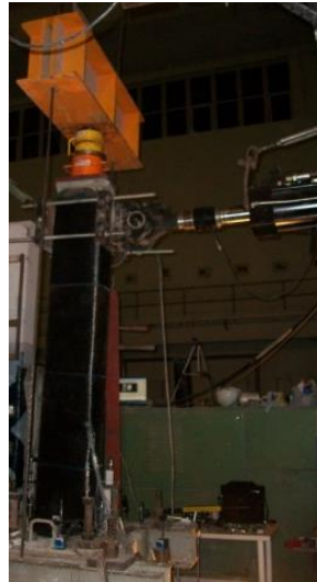
Şekil 4.14 : LAM-LAM numunesi deney sonrası ( P= 0 kN, \delta = -59,50 mm).
