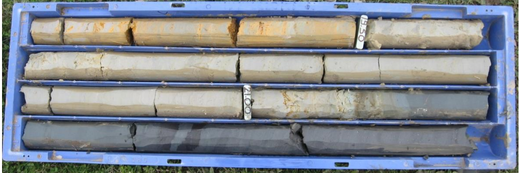
Şekil 3.6 : BH75-3 nolu sondajda gözlenen killi seviyelerden bir örnek.
