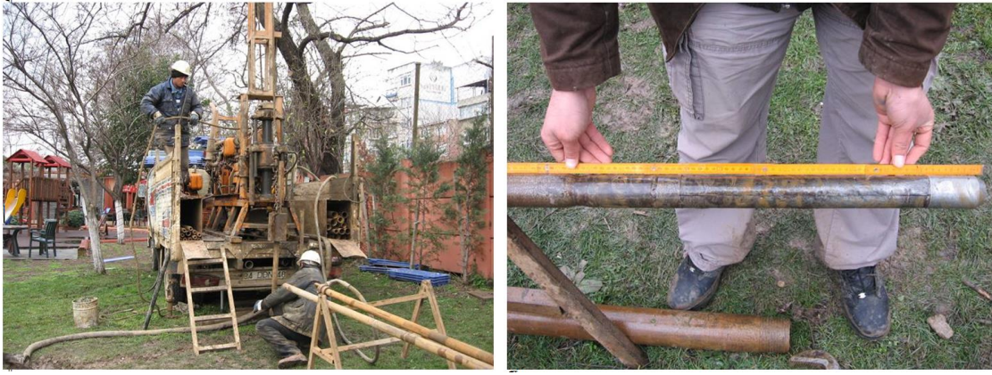
Şekil 4.2 : Standart Penetrasyon Deneyinin uygulanışı ve örnek alıcı (Nakazawa, 2009).
