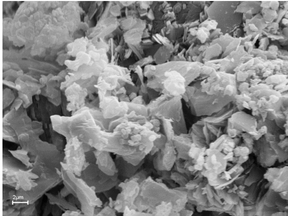
Şekil 5.12 : Düzensiz yığılımlar halindeki kuvars mineralleri içinde dağınık halde bulunan kaolinit mineralleri. ( Çal-10)
