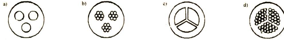
Şekil 1.2 Kabloların damar iletkeni kesitleri
